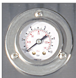
Pression contrôlable grâce au manomètre.
